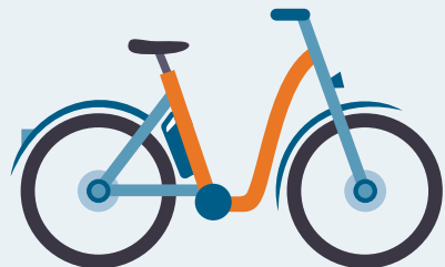
Tiefeinsteiger ermöglichen ein problemloses Auf- und Absteigen; der Akku ist nicht im Weg
